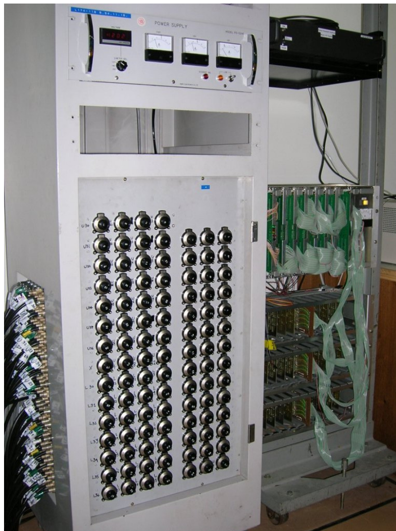
Figura 4.3 – Fontes de alimentação e sistema de processamento de sinais do telescópio detector de muons.
